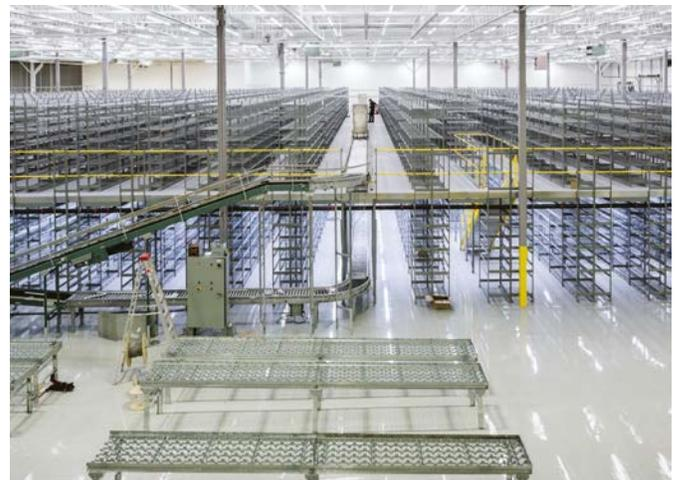
Système à paliers multiples en utilisant les étagères Série-E personnalisées pour les convoyeurs dans une entrepôt avec des planchers inégaux.
