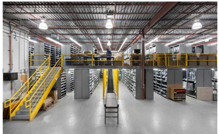
Système à paliers multiples utilisant des étagères Interlok personnalisées pour les convoyeurs dans un entrepôt de fabrication de vêtements.
